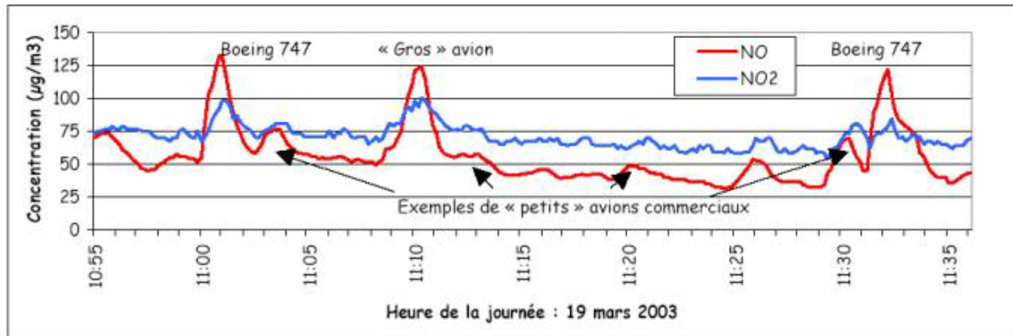
Figure 21 : Evolution des niveaux des oxydes d'azote au site de Paray-Vieille-Poste entre 10h55 et 11h35 le mercredi 19 mars 2003, ainsi que les avions au décollage recensés par Airparif.
